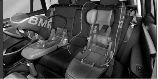
La fijación del Baby Seat 0+ o el Junior Seat 1 en el vehículo enganchando los anclajes ISOFIX del vehículo a la base ISOFIX cumple las condiciones de homologación "semiuniversal" y está autorizada conforme a la norma europea para sistemas de retención infantiles ECE R44/04.
