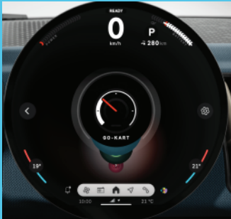
Unidad interactiva MINI. Pantalla central OLED con un área de 440 cm².
