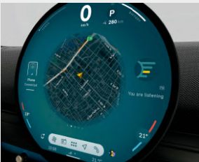
Unidad interactiva MINI. Pantalla central OLED con un área de 440 cm².
